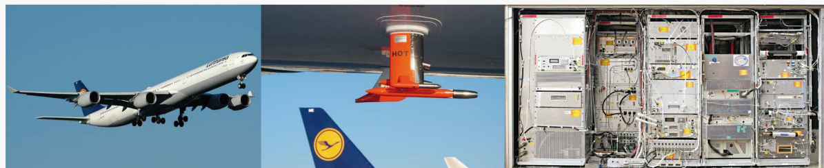
Abb. 1: Der Lufthansa Airbus A340-600 „Leverkusen“ (links), das Einlasssystem mit drei Einlassrohren (Mitte) und der 1,6 Tonnen schwere Messcontainer mit Geräten (rechts). © Max-Planck-Institut für Chemie / Brenninkmeijer
